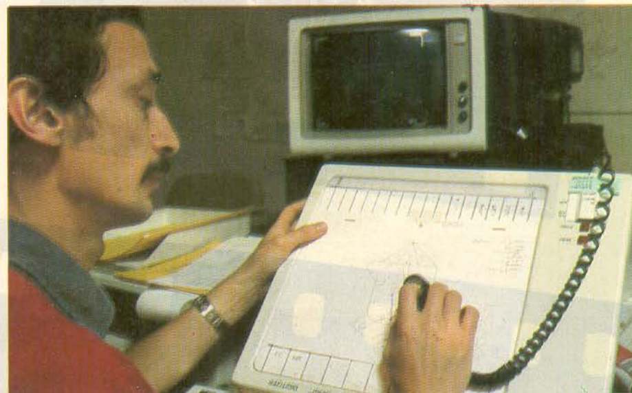
Avec le système Comparetti, l'animateur introduit les dessins-clés point par point sur une tablette à numériser.
